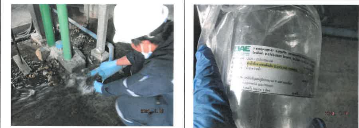
รูปที่ 3-2 การติดตามตรวจสอบคุณภาพน้ำที่ออกหอผึ่งเย็น บริเวณท่อน้ำทิ้งจากหอผึ่งเย็น (Cooling Tower)
